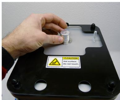
13. Поместите зуботехническую кювету на Flexpress™ компании Myerson, отцентрировав отверстие матрицы зуботехнической кюветы над центром нагревательной камеры. Заблокируйте зуботехническую кювету на месте, используя ремень и ручки зуботехнической кюветы.
