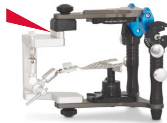
Abbildung zeigt den Übertragungsschlitten #10047 im Arto Artikulator mit 126 mm Bauhöhe. Die Inzisalteller-Auflage ist unter den Inzisalteller geschwenkt. Bei einer Bauhöhe von 116 mm ist die Inzisalteller-Auflage zur Seite geschwenkt.
