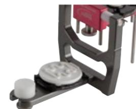
Connect Manschette aufsetzen und mit Gips befüllen
