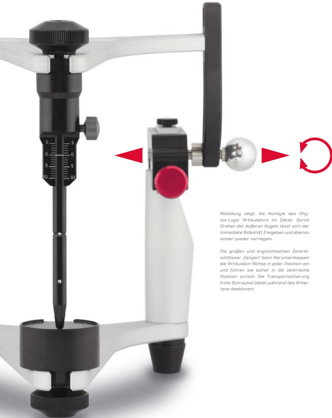
Abbildung zeigt: die Kondyle des Physio-Logic Artikulators im Detail. Durch Drehen der äußeren Kugeln lässt sich der Immediate Sideshift freigeben und ebenso sicher wieder verriegeln.
