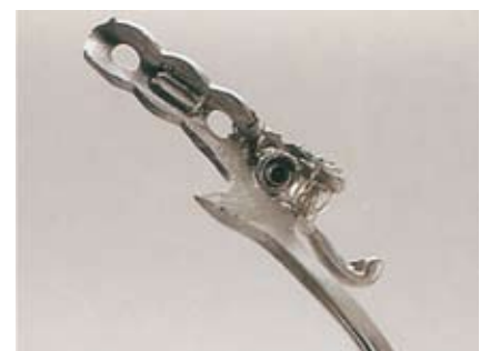
49 Säubern Sie den Boden der Gewindekappe mit der Handfräse Nr. 383 von evtl. noch anhaftenden Einbettmasseresten. Benutzen Sie Öl als Schmiermittel.
