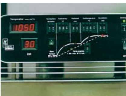
47 Um ein zu starkes Oxydieren der Fixierschraube zu vermeiden, sollte die Endtemperatur (950-1050°C) nicht länger als 30 Min. auf die Muffel einwirken.
