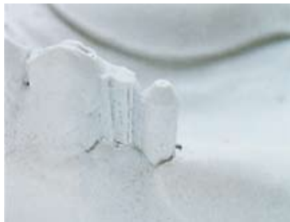
24 Dublieren Sie nach Vorschrift. Das Klebehilfsteil ist nach dem Entfernen der Dubliermasse deutlich auf dem Einbettmassemodell zu erkennen.
