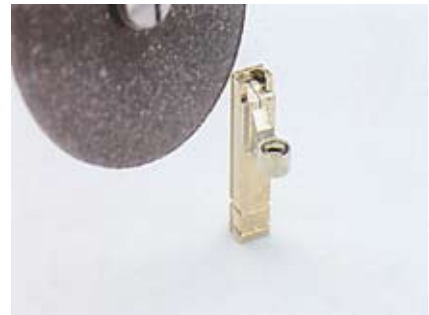
91 Mit einem geeigneten rotierenden Schleifinstrument werden die Matrizen auf die Höhe der Matrizen eingeschliffen.
