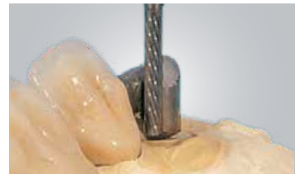
Технология фрезеровки: Brealloy C+B 270 превосходно поддается фрезерованию.
