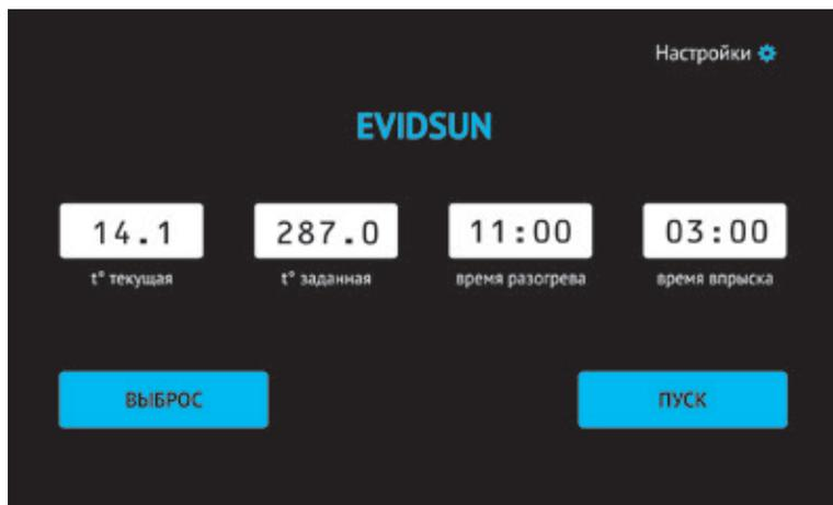
Таймер времени разогрева остановится на нулевом значении, а таймер времени впрыска начнет обратный отсчет. Во время впрыска автоматически отключается нагрев, поэтому температура падает.
